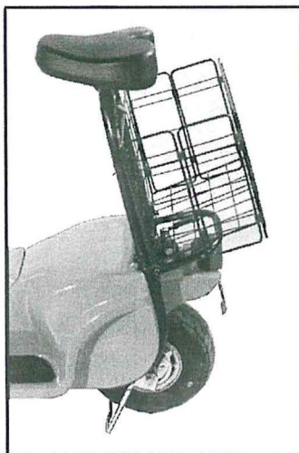
Bild 4 Gepäckträger, im Bild mit dem als Zubehör lieferbaren, faltbaren Gepäckkorb
